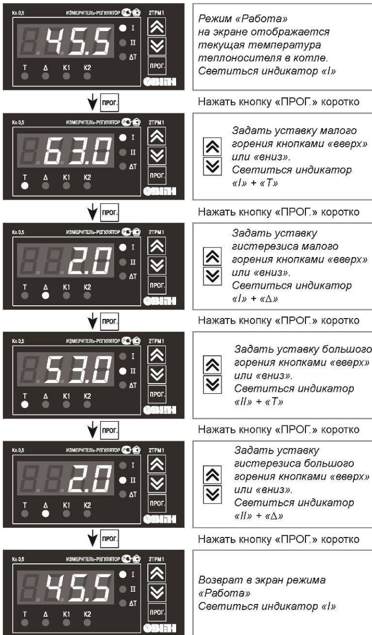
Рисунок 22. Изменение уставок малого и большого горения котла
