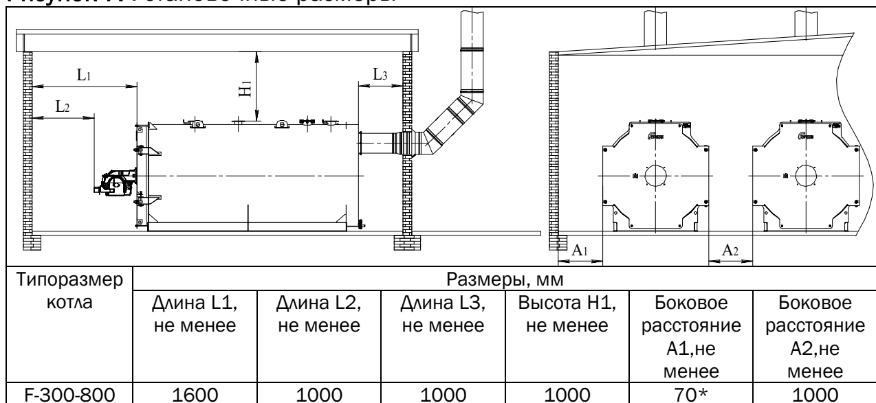
Рисунок 7. Установочные размеры
