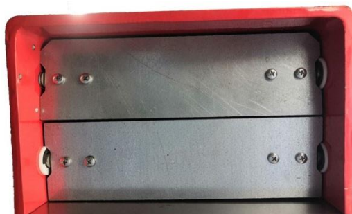
Рисунок 2.7 - Положение шиберов в закрытом положении (вид снизу)
