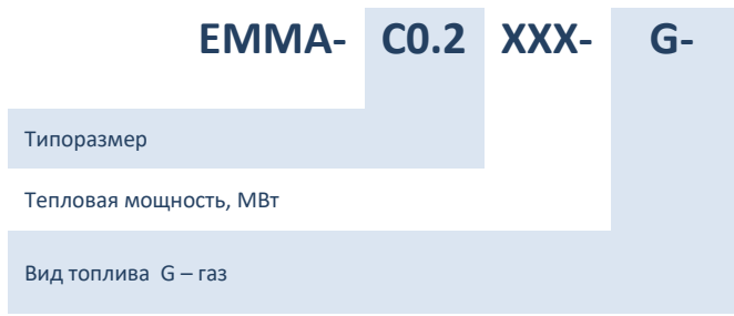
Рисунок 1.1 – Расшифровка кода обозначения горелок ЕММА
