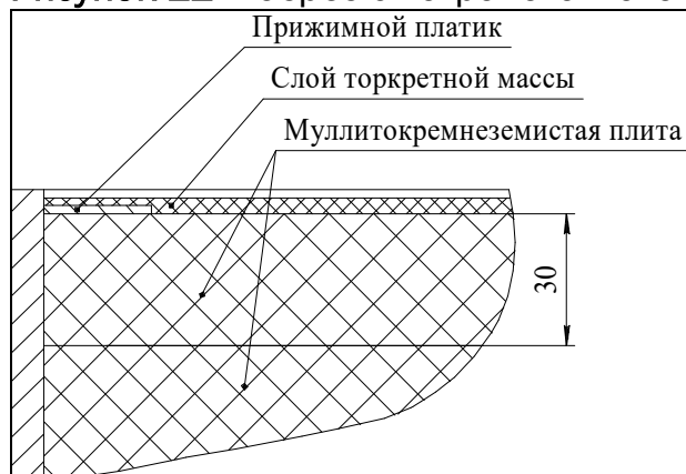
Рисунок 12. Разрез смотрового люка
