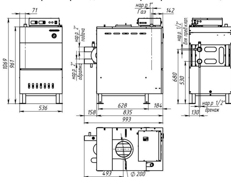
Рисунок 2. Габаритно-присоединительные размеры котла RSA80
