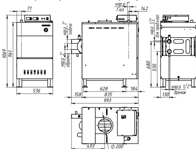
Рисунок 2. Габаритно-присоединительные размеры котла RSA80
