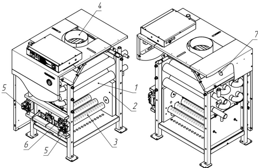
1 - оребренная труба теплообменника, 2 – теплоизоляция топки, 3 - рожок горелки,
