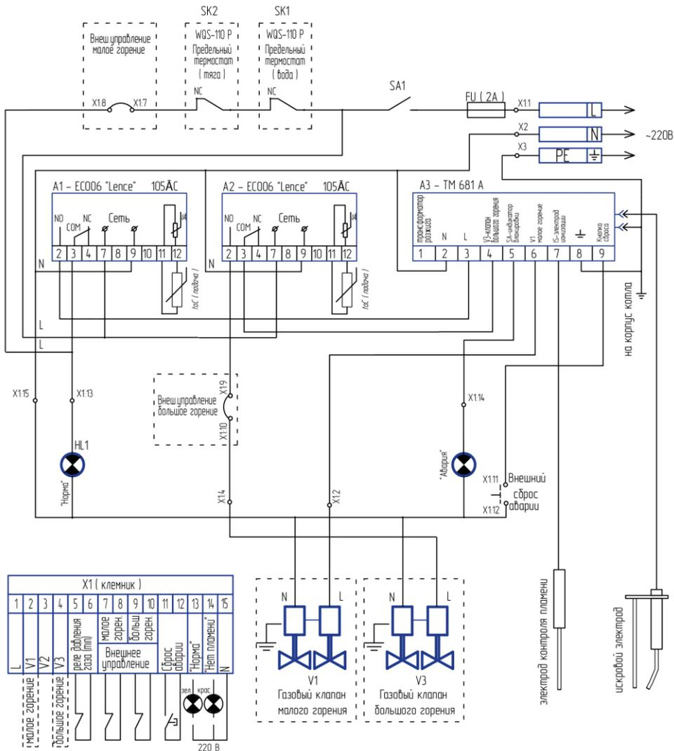
SK1 – термостат предельный (вода), SK2 – термостат предельный (тяга),
