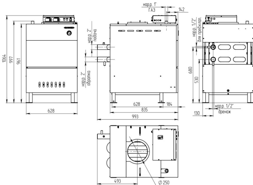
Рисунок 3. Габаритно-присоединительные размеры котла RSA100
