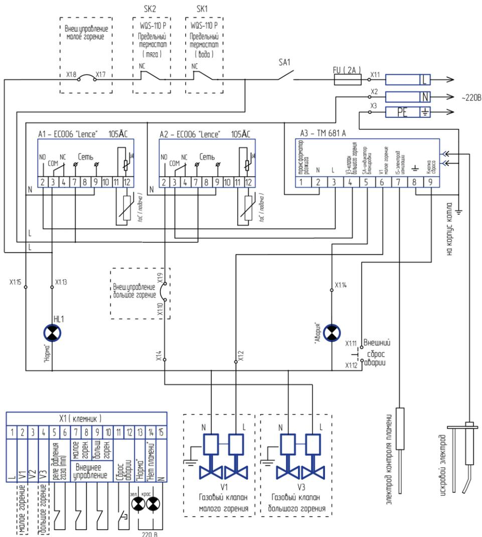
SK1 – термостат предельный (вода), SK2 – термостат предельный (тяга), VP1- реле минимального давления газа (только у котлов RSA250-500), A1 – регулятор малого горения, A2 – регулятор большого горения, A3- автомат розжига, V1+V2 – клапаны малого горения, V3 – клапан большого горения.
