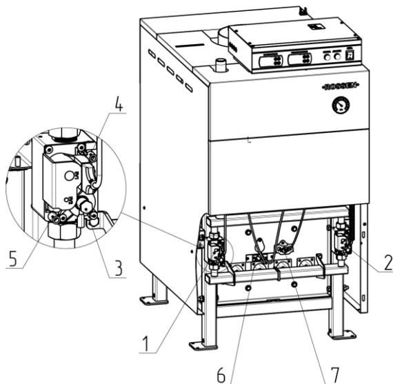
1 – первый клапан, 2 – второй клапан, 3 – винт регулировки давления газа на выходе с клапана (регулирующий винт под колпачком), 4 – штуцер для замера входного давления, 5 – штуцер для замера давления на выходе с газового клапана, 6 – электрод розжига и контроля пламени, 7 – датчик тяги
