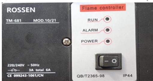
Рисунок 10. Внешний вид автомата розжига
