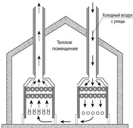
При переводе котла в резерв (отключении котла) рекомендуется перекрыть шибер на дымоходе, в противном случае возможно «опрокидывание» тяги, что создаст риски замораживания теплоносителя в теплообменнике даже в теплых помещениях.
