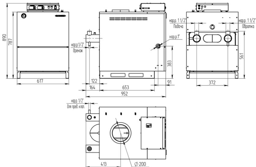
Рисунок 1. Габаритно-присоединительные размеры котла RSA40, RSA60
