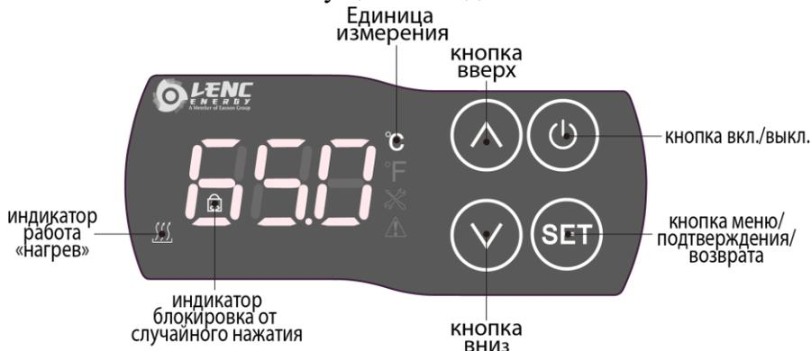
Рисунок 11. Экран регулятора температуры
