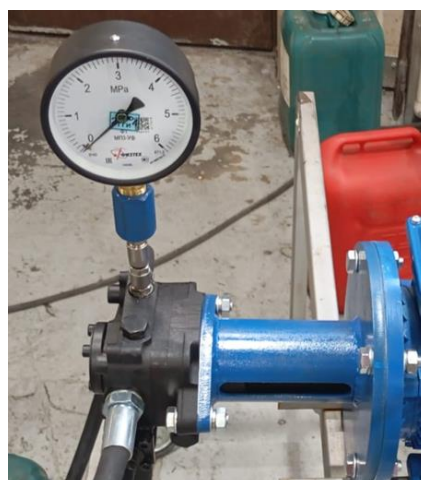
Рисунок 1.4 – Слева: обозначение пропускной способности форсунки; справа: установленный на корпусе насоса манометр.
