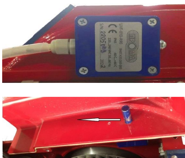
Рисунок 2.8 - Расположение фотодатчика на корпусе горелки
