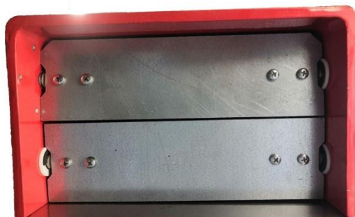
Рисунок 2.7 - Положение шиберов в закрытом положении (вид снизу)
