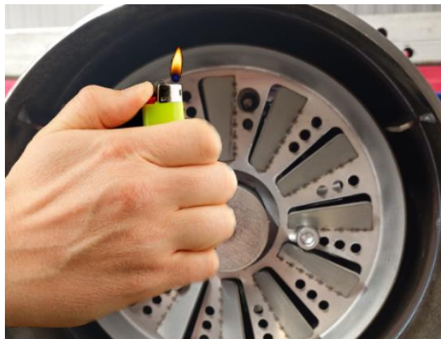
Рисунок 2.9 - Поднесение источника УФ излучения
