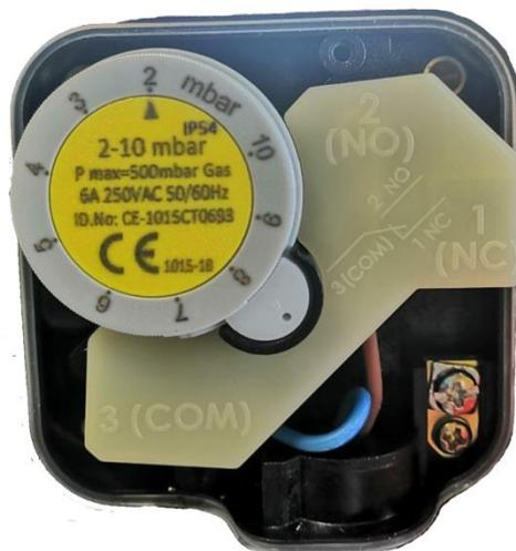
До начала работы горелки датчик находится в нормально разомкнутом положении. Как только запускается вентилятор, контакты реле замыкаются – датчик зафиксировал наличие перепада давления и дает разрешение на дальнейшую работу горелки. В противном случае на передней панели блока управления могут возникнуть две ошибки: «Залипание реле воздуха» или «Нет давления воздуха». И запускается процесс аварийной вентиляции горелки.
