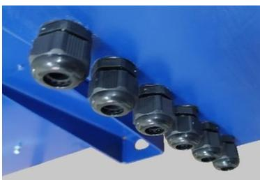
Через данные гермовводы подключить сигналы управления к разъемам ХТ12, ХТ14 блока расширения Т410.
