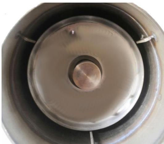
3) Проверка работы вентилятора. «Вентилятор» – ⏪ – «Проверка вентилятора» – «ВКЛ→», после чего запустится вентилятор. Важно проследить за направлением вращения лопастей вентилятора: если смотреть со стороны установки вентилятора, то крыльчатка будет вращаться против часовой стрелки.
