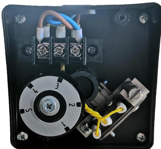
Датчик-реле минимального давления газа РД-016-10 настроить на 0,5 кПа
