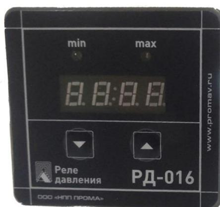
Реле давления газа установлено на газовой рампе перед блоком клапанов и контролирует давление в газовой рампе, чтобы препятствовать работе горелки, когда давление газа не будет соответствовать рабочему диапазону, т.е. ниже минимальной и выше максимальной уставки.
