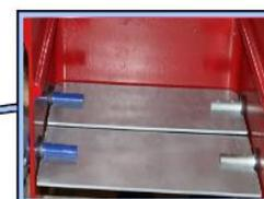
Система регулирования расходом воздуха с двумя заслонками
