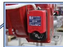
Электропривод DM-04-230 воздушной заслонкой
